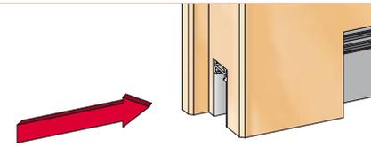
5. Aluminiumschiene festschrauben
