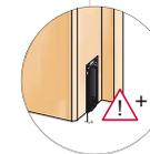
wird das Dichtprofil bündig abgeschnitten, ist Phone Stop erforderlich
