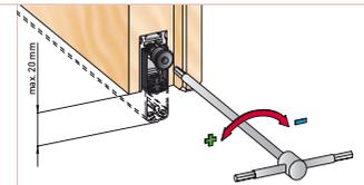
Einstellen von unebenem Boden bzw. Hubhöhe nur auf der Auslösesseite mit einem 3 mm Inbusschlüssel.
