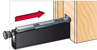
Mechanik bis zum Einrasten einführen, Boden- bzw. Hubhöhe einstellen
